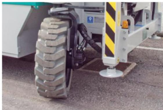
↳ Nivellement automatique sur terrain inégal ou en pente.
