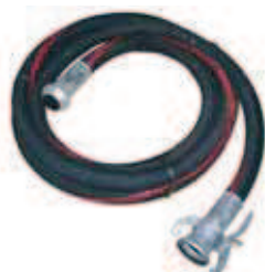
Tuyau à matériaux Ø 65 mm avec raccords Perrot (limite de pression : 10 bars)
