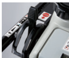
Levier de commandes 3 fonctions : - permet d'accélérer, - de couper le moteur, - et de couper l'essence
