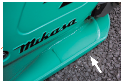
n La partie arrière de la semelle, où l'usure est la plus marquée, est une semelle double ce qui garantit une meilleure longévité de celle-ci pour tous types de travaux. (MVC-F60 / F80)
