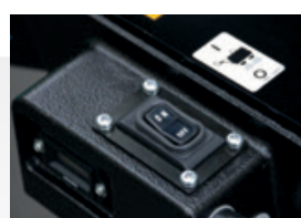
Bouton électromagnétique pour les vibrations
