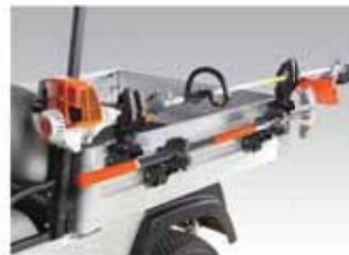
Porte-outils à cliquet (En haut) Porte-outils standard (En bas)
