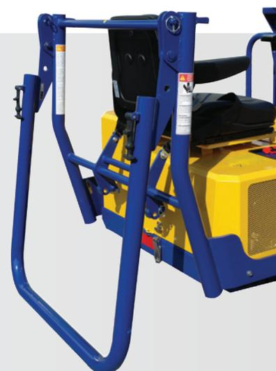
• **ARCEAU DE SECURITE REPLIABLE - ROPS**
