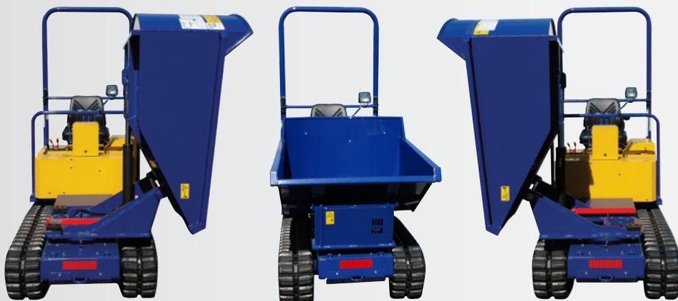
• **BENNAGE A 90° ET BENNE ROTATIVE A 180°**
