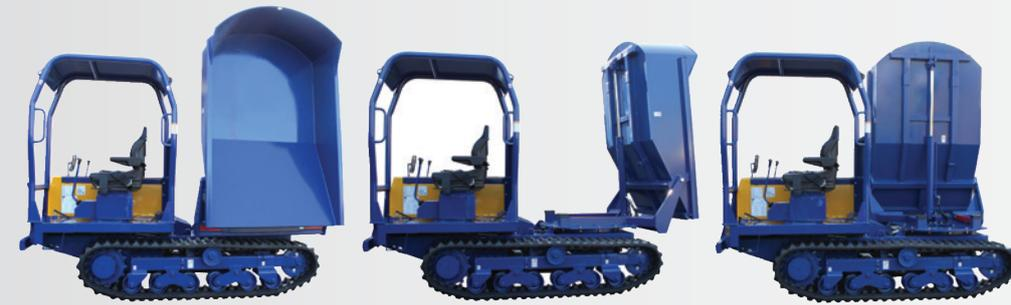
• **BENNAGE A 90° ET BENNE ROTATIVE A 180°**
