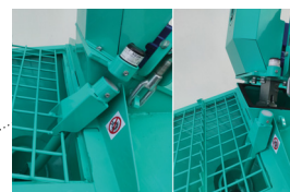
Capteur de sécurité de grille de trémie.
