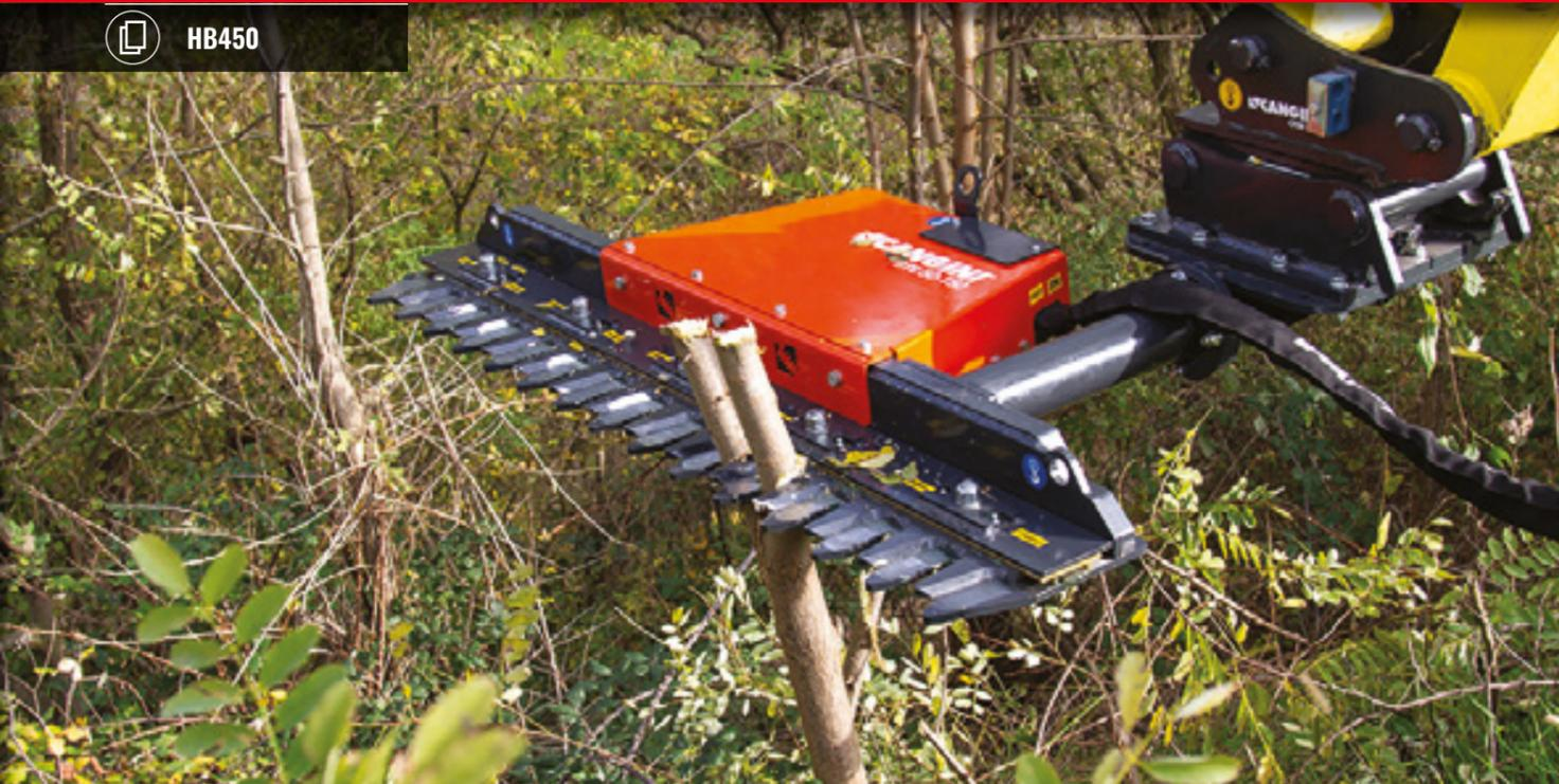
CETTE BARRE SHARP-CUT D'ÉLAGAGE EST ADAPTÉE À LA TAILLE DE BRANCHES JUSQU'À 100 MM. ELLE N'ABÍME PAS LA PLANTE EN EXÉCUTANT UNE TAILLE NETTE ET PRÉCISE QUI NE DÉCHIRE PAS LA BRANCHE. SES LAMES SONT EN HB450, CE QUI ASSURE RÉSISTANCE ET DURETÉ DANS LE TEMPS.
